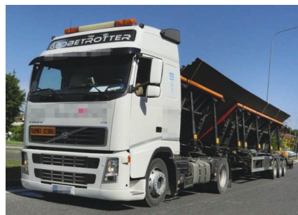
Figura 14: lastre di acciaio trasportate con un'inclinazione di 45°
