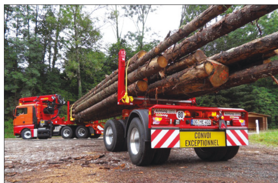
Figura 54: fissazione di alberi interi
