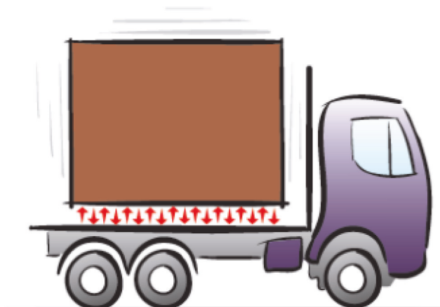
Figura 3: vibrazione verticale durante la guida
