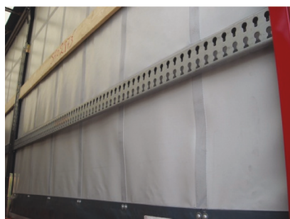
Figura 27: listello di alluminio con fori per barre di bloccaggio
