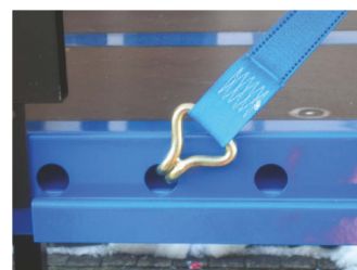
Figura 13: foro di ancoraggio nel profilo laterale
