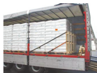
Figura 39: ancoraggio antirimbalzo tramite pallet
