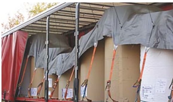
Figura 31:fissazione con copertura
