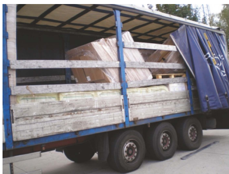
Figura 19: insufficiente fissazione del carico solo con film estensibile
