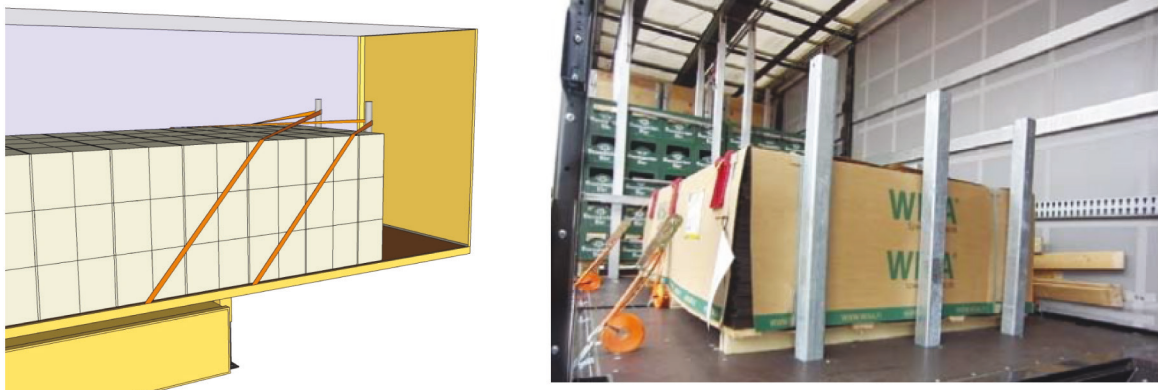
Figura 7: montanti utilizzati per il bloccaggio in avanti
