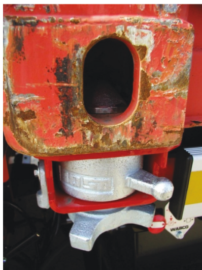
Figura 17: twistlock con container
