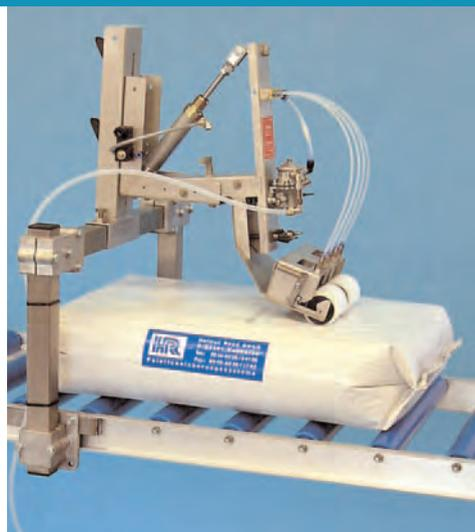
Questo straordinario sistema funziona in completa assenza di alimentazione elettrica. Il nastro trasportatore, che trasporta il pacco, solleva il braccio di applicazione con i due rulli doppi. Questo movimento aziona meccanicamente una pompa a membrana regolabile, che distribuisce il GRIP FIX™ attraverso 4 ugelli sui rulli di spugna o di feltro.
