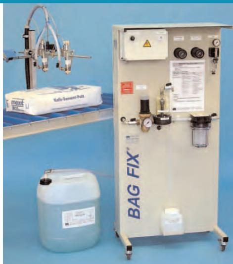
Il BAG FIX ESP-2 permette un vasto campo d'impiego: dall'applicazione di cordoli a quella spray, fino all' applicazione finissima della nebulizzazione. Un sensore luminoso identifica i pacchi e aziona le pistole a spruzzo mediante un dispositivo di comando programmabile. Una pompa a doppia membrana trasporta il GRIP FIX™ attraverso un filtro alle pistole che vengono controllate mediante un sistema di segnalazione di vuoto ed un pressostato.
