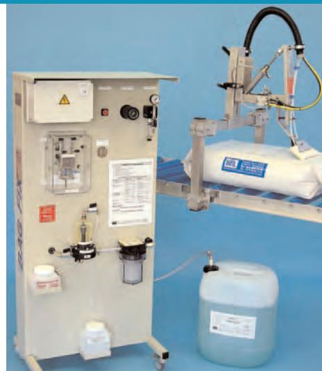
L'impianto si trova lungo l'alimentazione del pallettizzatore. Il nastro trasportatore, che trasporta il sacco di PE, solleva il braccio di applicazione con la tasca di feltro attivando così il segnale della pompa. Una quantità ridotta di circa 0 fino a 2,0 g di GRIP FIX™ viene dosata all'interno della tasca di feltro e applicata sulla superficie del sacco.
