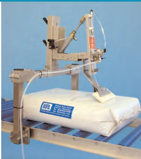
Questo straordinario sistema funziona in completa assenza di alimentazione elettrica. Il nastro trasportatore, che trasporta il sacco di PE, solleva il braccio di applicazione con la tasca di feltro. Questo movimento aziona meccanicamente una pompa a membrana regolabile, che dosa il GRIP FIX™ all'interno della tasca di feltro.
