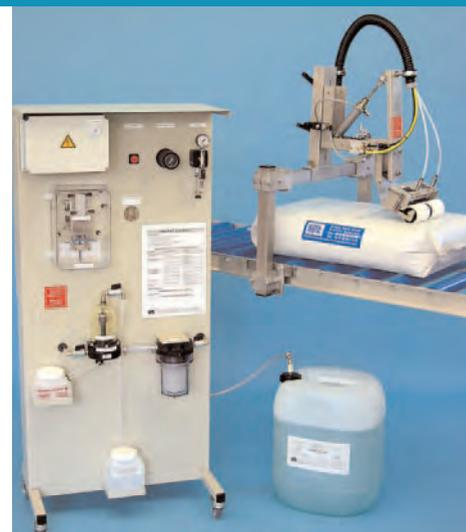
L'impianto si trova lungo l'alimentazione del pallettizzatore. Il sacco di PE solleva il rullo di applicazione attivando così il segnale della pompa. Una quantità ridotta di circa 0 fino a 2,0 g di GRIP FIX™ viene applicata mediante rulli di feltro o di spugna sulla superficie del sacco.
