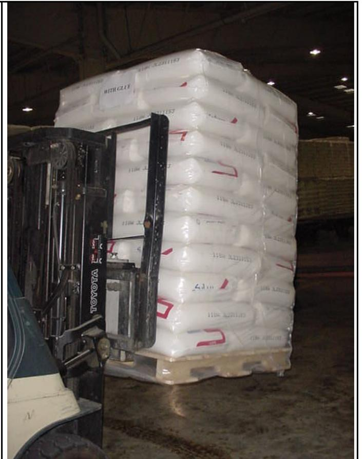
**Il test è stato effettuato su 2 pedane. Il muletto ha inclinato il carico fino al massimo delle sue possibilità. Il carico è rimasto inclinato per 5 minuti.**
