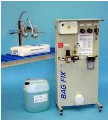
Sistema di fissaggio di sacchi e cartoni sulle pedane attraverso l'uso di GRIP FIX™ collante e BAG FIX™ macchinario per l'applicazione del collante.
