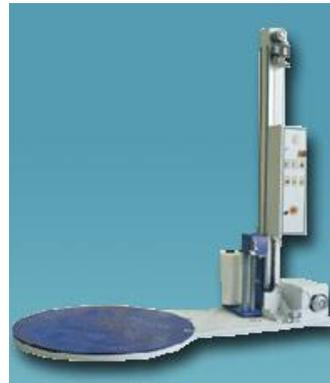
Sistema di fissaggio di sacchi e cartoni sulle pedane con la metodologia tradizionale: avvolgitore automatico o semiautomatico e film estensibile.
